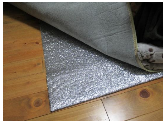
断熱マットで床へ熱が逃げるのを防ぐ
