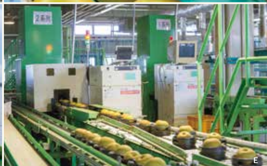
A. 「新高」は台湾で1玉2,000円以上の高値がつく高級フルーツ。その他、香港・ベトナム・シンガポール・タイへ、さまざまな品種の梨を輸出している。B.最盛期は100名を越えるスタッフが選果場で作業をする。C.大規模な選果場。梨の保冷库と直売所も隣接している。D.最終チェックもかねて、人の手で箱詰め。E. 光センサーでは糖度・熟度・内部障害・褐変・果形の5項目で測定し、記録している。
