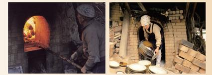
窯をあたためるための薪には古材を使い、焼成に使う薪は主に杉の端材を使う。焼成には登り窯を用いる。火を入れると、共同窯では約55時間、夜通し焚き続ける。
