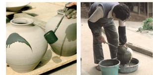
伝統的な装飾として、器に柄杓でかける「打ち掛け」と、器の胴部に縦に流す「流し掛け」が、代表的なもの。
