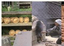
濃縮した泥水を「オロ」と呼ばれる濾過槽で水抜き。さらに、天日や窯の上で乾燥させると陶土が完成。
