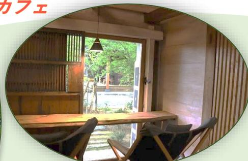
明治37年築上の蔵をカフェ仕様にリノベーション。2階の床を抜いて吹き抜けにして土壁はそのまま生かし、断熱材は使っていないが、中はとても涼しい。昔あった建具を外してガラスをはめ、中から外を眺めることができる。緑溢れる景色がいい。
