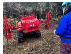
多目的造林機械 (植栽作業)
