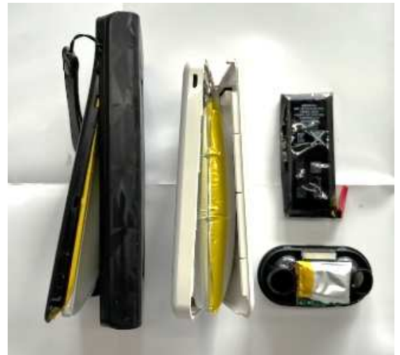
膨張した蓄電池
